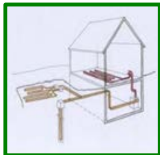
Pompe à chaleur PAC Eau/ Eau
