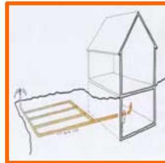
Puits climatique + PAC
